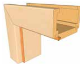
Řez obložkovou zárubní (OKZ) přes původní kovové zárubně síla zdi od 50 mm, límce 80 mm
