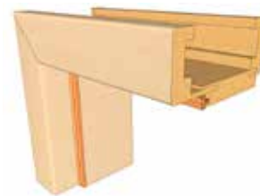
Řez obložkovou zárubní pro otočné bezfalcové dveře síla zdi od 100 mm, límce 60 mm
